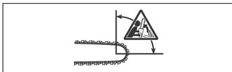
Le rebond se produit toujours dans le plan du guide-chaîne. Généralement, le produit est projeté contre l'opérateur, mais il peut aussi se déplacer dans une autre direction. C'est la façon dont vous utilisez le
