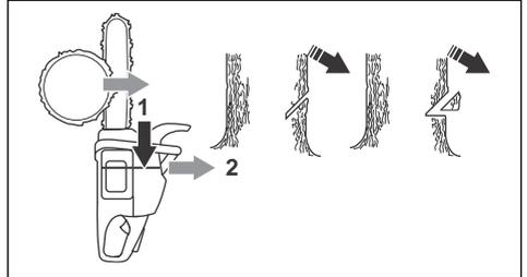
2. Assurez-vous que l'entaille inférieure est horizontale et à un angle de  $90^{\circ}$  par rapport au sens de la chute.
