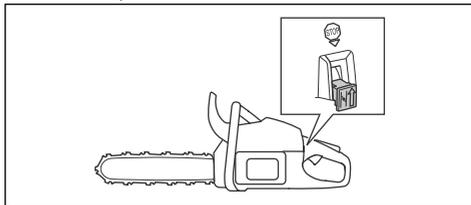
Votre produit est doté de la fonction qui règle le carburateur automatiquement, ce qui assure le meilleur réglage possible. permet au moteur de s'adapter aux conditions climatiques, à l'altitude, à l'essence et au type d'huile deux temps.
