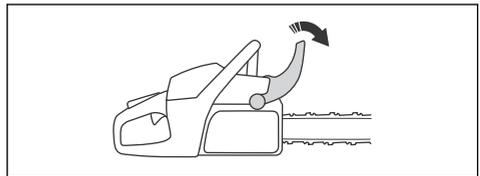
2. Tirez l'interrupteur marche/arrêt (A) vers vous puis vers le haut pour le mettre en position de démarrage.
