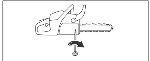
5. Serrez les écrous du guide-chaîne à l'aide de la clé et soulevez en même temps l'extrémité avant du guide-chaîne.
