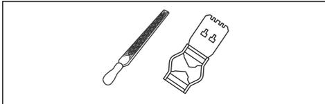
1. Pour le réglage de la jauge de profondeur, utilisez une lime plate et un gabarit d'affûtage. Utilisez uniquement le gabarit d'affûtage Husqvarna pour obtenir l'épaisseur souhaitée et le bon angle pour la jauge de profondeur.
