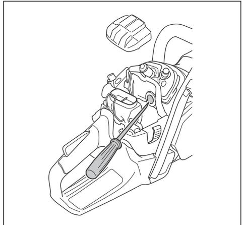
3. Un capot d'hiver est disponible en cas de températures inférieures à -5 °C (23 °F) ou par temps neigeux. Montez le capot d'hiver sur le corps du lanceur. Le capot d'hiver diminue le débit d'air frais et empêche la neige de pénétrer dans la zone du carburateur.
